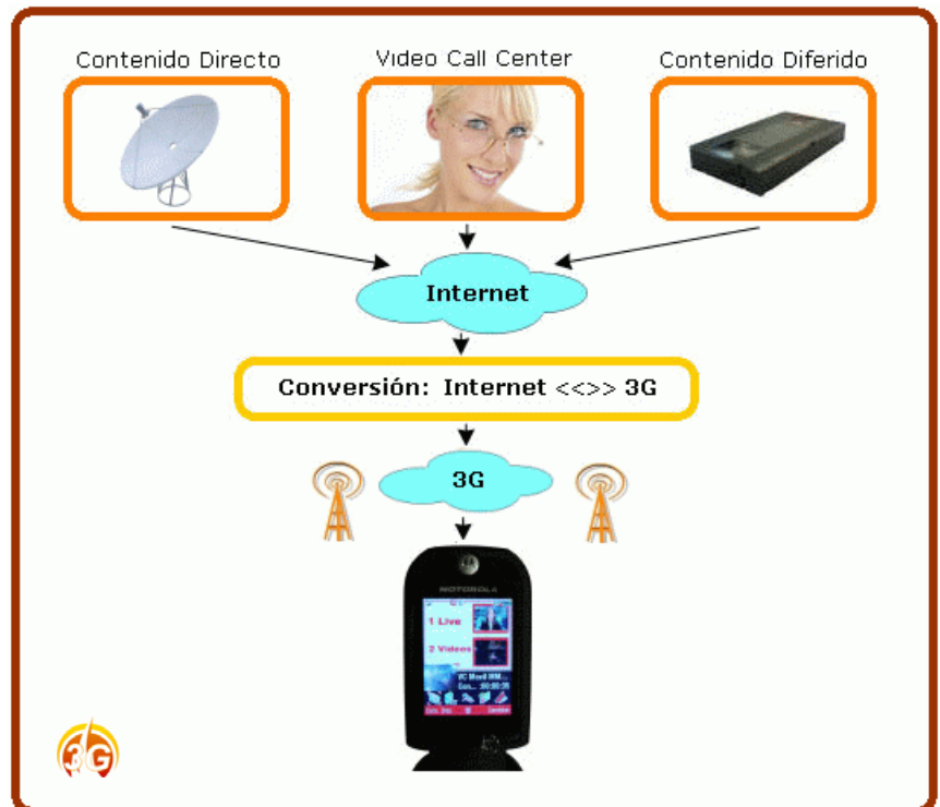
Funcionamiento sistema 3G
